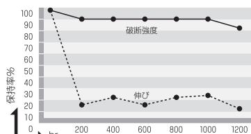
試験方法: 耐候性試験(サンシャイン・カーボンアーチ式ウェザーメーター)の中に入れ照射後の破断強度・伸びの保持率を%で表した。
