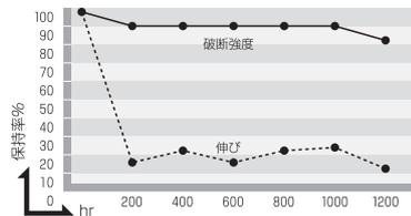
試験方法: 耐候性試験(サンシャイン・カーボンアーク式ウェザーメーター)の中に入れ照射後の破断強度・伸びの保持率を%で表した。
